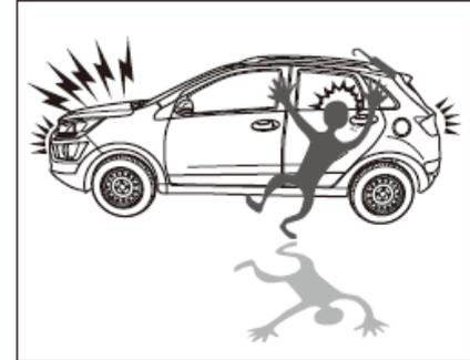
Wenn das Fahrzeug mit der Fernbedienung verriegelt ist, befindet sich das gesamte Fahrzeug im Sicherungszustand und alle Türen, Motorraumhaube und Kofferraumdeckel befinden sich im Überwachungszustand. Wenn die Tür, Kofferraumklappe oder Motorraumhaube mit Gewalt geöffnet wird, wird der Alarm ausgelöst.
