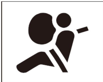
Die Warnleuchte des Airbag-Systems auf der Instrumententafel erinnert Sie an einen Fehler im Airbagsystem.
