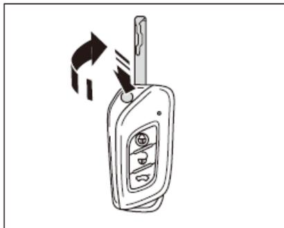
Wenn die Taste auf der Fernbedienung nach unten gedrückt wird, springt der mechanische Schlüssel automatisch hoch. Zum Entfernen des mechanischen Schlüssel drücken Sie zuerst die Taste und klappen Sie dann den mechanischen Schlüssel heraus.
