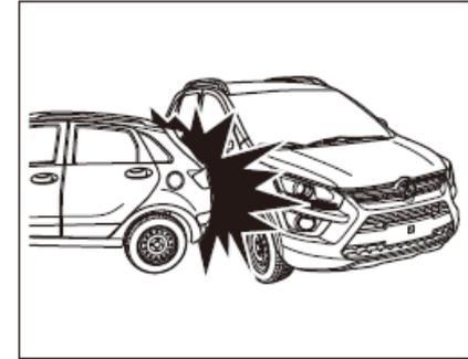
Im Falle eines seitlichen Zusammenstoßes bewegt sich der Insasse in Richtung des Zusammenstoßes, der Airbag, der sich vor dem Insassen aufbläst, schützt den Insassen nicht. Es ist wahrscheinlich, dass der Airbag nicht aufgeblasen wird.
