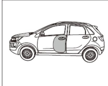
Bei einem Seitenzusammenstoß entscheidet die Airbag-Steuereinheit, ob der Seitenairbag aufgrund der vom Seitenzusammenstoßsensor und vom Beschleunigungssensor in der Steuereinheit empfangenen Signale, aufblasen soll.
